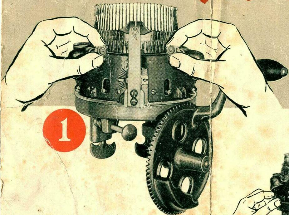
Abaisser les leviers du bas pour mettre en action les deux piqueurs qui relèvent les aiguilles. Tenir fermement votre ouvrage à l'intérieur du cylindre, de la main gauche.
